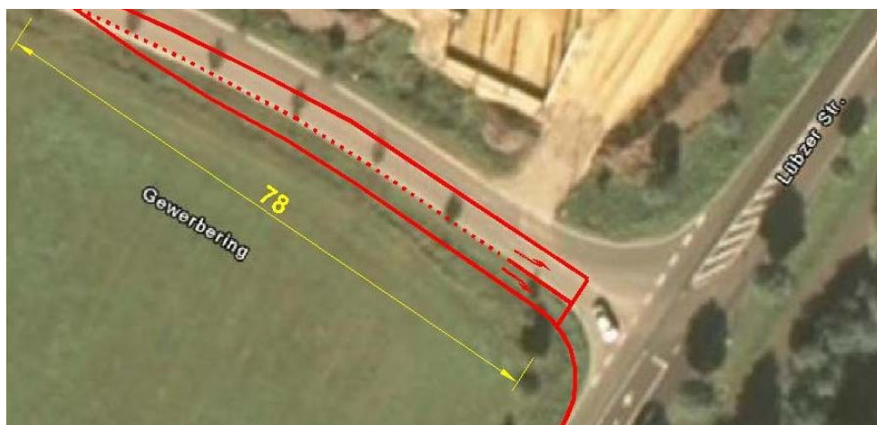
Abb. 8: Vorgeschlagene bauliche Maßnahme am Knotenpunkt K4
