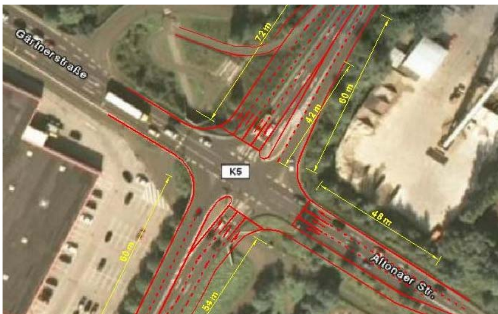
Abb. 10: Vorgeschlagene bauliche Maßnahme am Knotenpunkt K5
